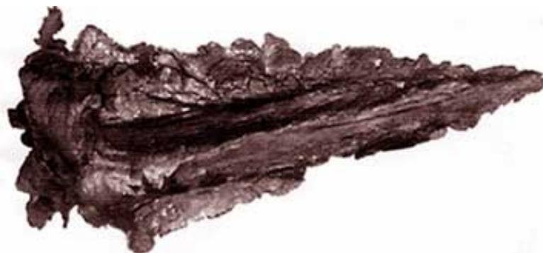
Рис. 4. Продукты износа при работе МРТ
